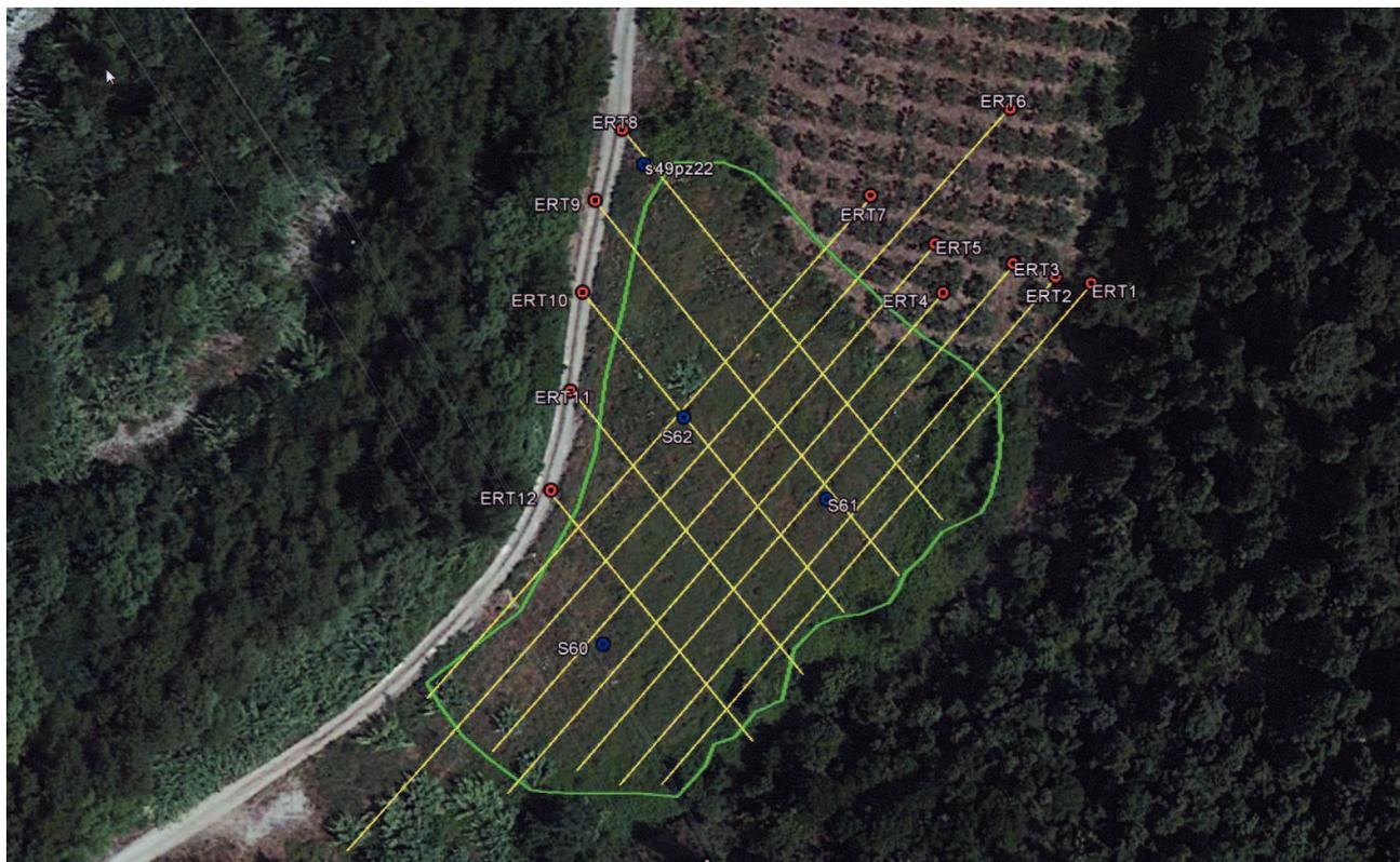
**Figura 2** SITO 1. In verde il contorno dell'area indagata con prospezioni elettromagnetiche; in giallo sezioni elettrotomografiche (ERT1 ÷ ERT12); in blu sondaggi a carotaggio continuo (S49pz22, S60, S61, S62) eseguiti durante il P.d.C. (immagine tratta Google Earth)
