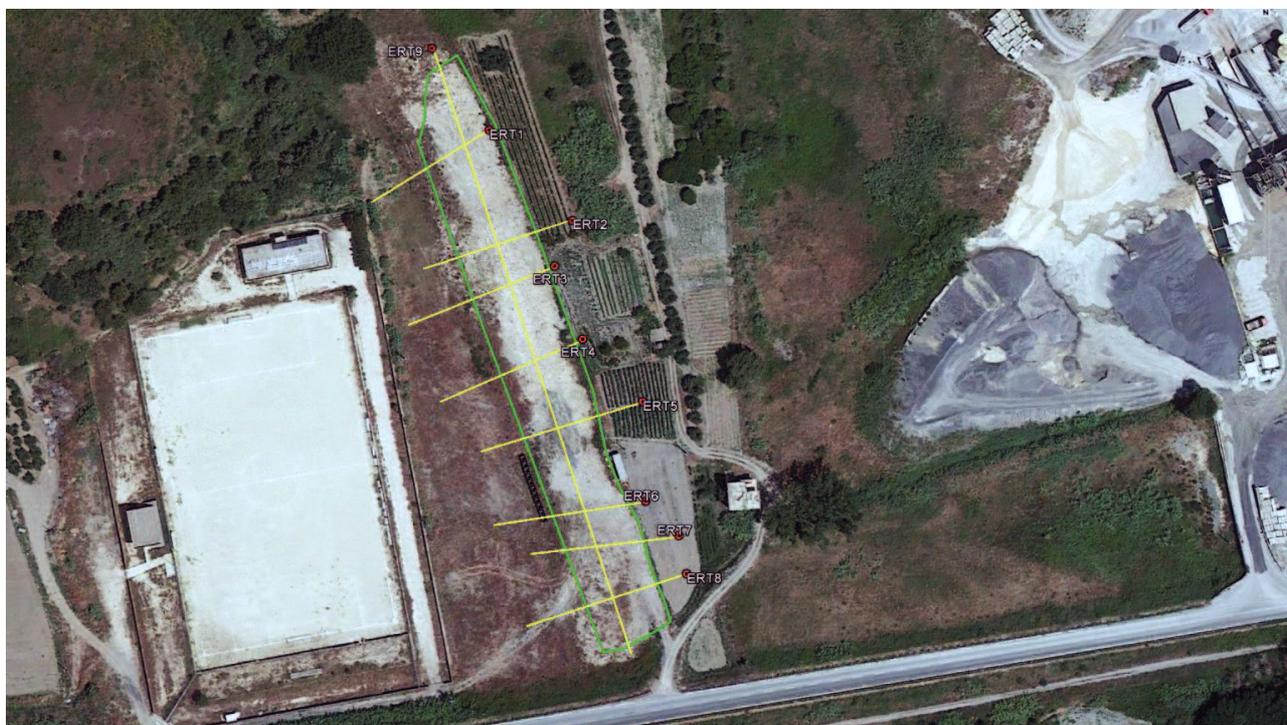
Figura 6. SITO 2. In verde il contorno dell'area indagata con prospezioni elettromagnetiche; in giallo sezioni elettrotomografiche (ERT1 ÷ ERT9) - Immagine tratta Google Earth.
