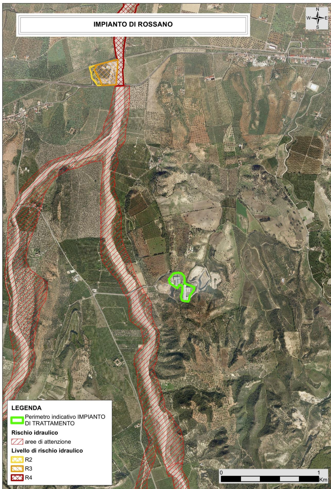
Figura 18 incoli PA – Rischio idraulico in impianto di Rossano (C)
